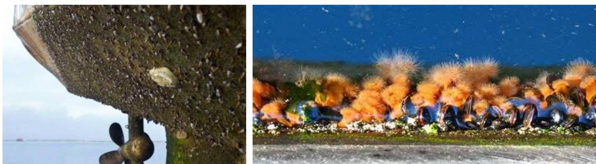
*Ce biofouling est ultra nocif pour les bateaux puisqu'il diminue la manoeuvrabilité, augmente sévèrement la consommation de fuel et détruit les supports (bio-corrosion).*
